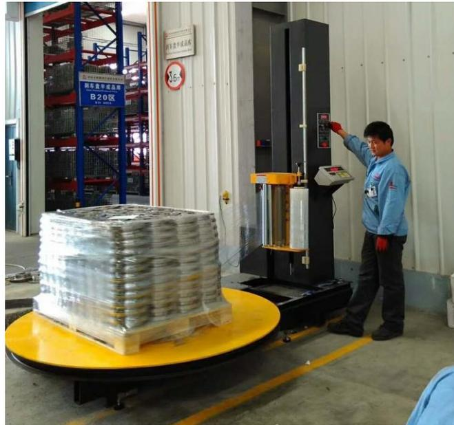
Photo 10 : Ensacheuse (wrapping machine)
