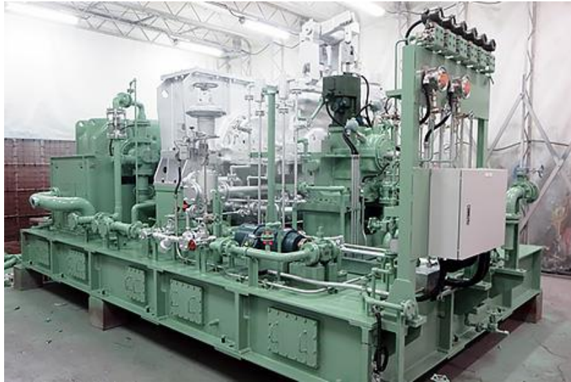
Photo 6 : Turbine à vapeur de condensation de 15MW - Shin Nippon C6
