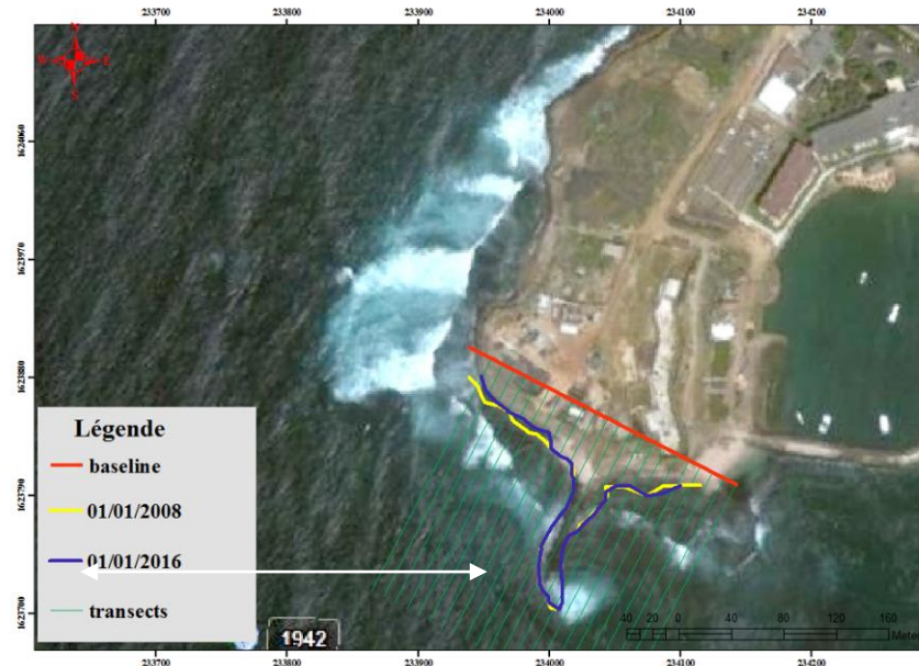
Figure 3 Extraction et mesure de la variation du trait de côte selon le concept du plugin DSAS (Digital Shoreline Analysis System)
